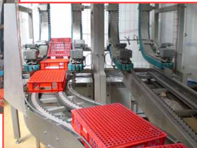
Pressbandförderer als Zulauf zur Waschmaschine (auf einer zweispurigen Waschmaschine bei einer Leistung von 4600 Kästen/Std).
