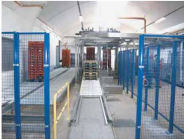
Palettenfördersystem mit Rollenbahnen,Palettenstapler Entnahmestation der Palettenstapel mit Handhubwagen
