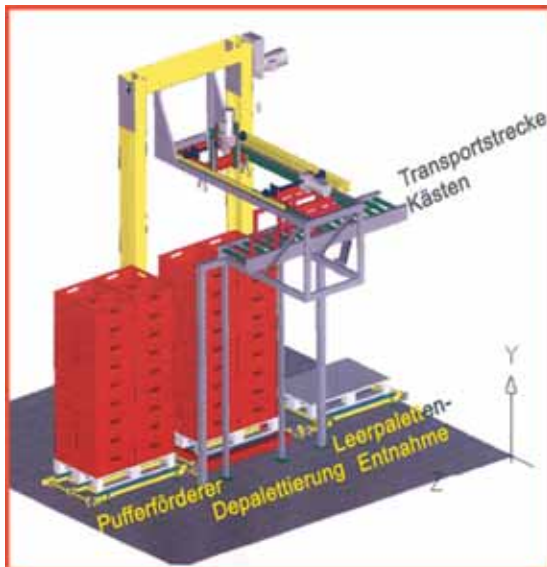
Automatische Depalettierung gefüllter Kästen direkt von der Palette Typ wb2001-1
