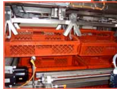
Automatische Depalettierung von Leerkästen direkt von der Palette mit einer Leistung von 2400 Stück pro Stunde
