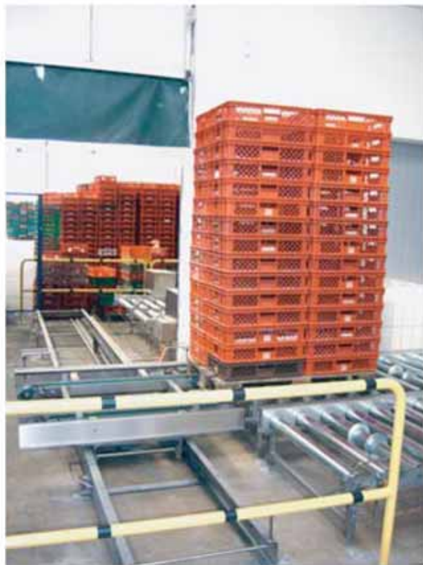
Verschiebesystem für Paletten.Zum Beispiel als Verbindung mehrerer Palettenrollen-Bahnen in einem Leerkasten-Lager .
