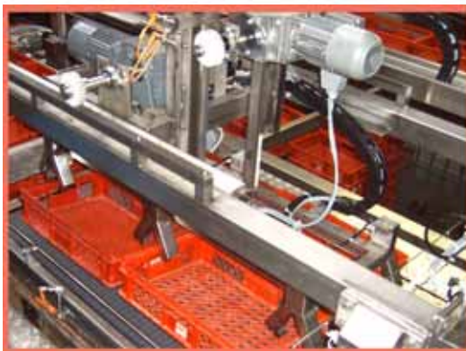
Automatische Depalettierung von Leerkästen direkt von der Palette mit einer Leistung von 2400 Stück pro Stunde
