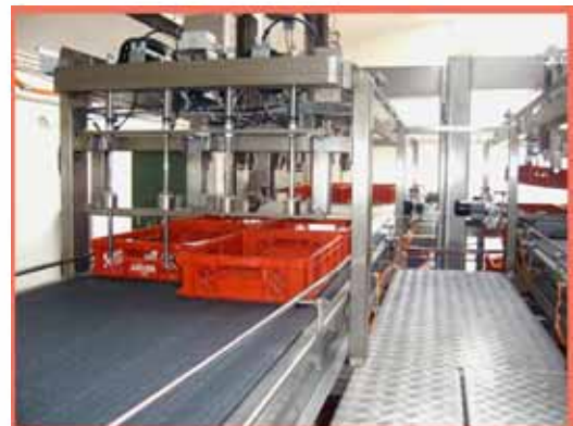
Automatische Depalettierung von Leerkästen direkt von der Palette mit einer Leistung von 2400 Stück pro Stunde
