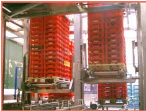
Automatische Depalettierung von Leerkästen direkt von der Palette mit einer Leistung von 2400 Stück pro Stunde
