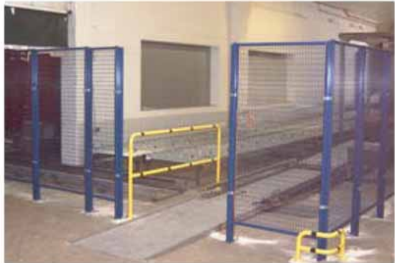
Palettenfördersystem mit Rollenbahnen,Palettenstapler Entnahmestation der Palettenstapel mit Handhubwagen
